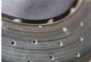
4 Les trous des disques ventilés ne doivent pas être obstrués.
