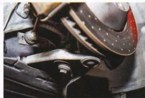
6 La biellette de barre stabilisatrice possède 4 trous de réglage à l'avant.
