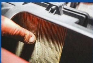
2 Le filtre à air doit être propre si l'auto est bien entretenue.
