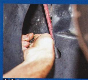
A B De l'avant, on ne peut pas savoir si des graviers sont venus se loger. Il faut passer la main dans l'écope située derrière la roue.
