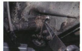
**8** Autre point à inspecter, le point d'ancrage du train arrière.
