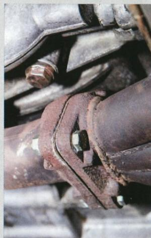
**8** Les vis de l'échappement ont tendance à rouiller et à se gripper avec le temps. Il est préférable de les changer en prévention.
