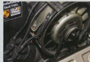
**2** Le faisceau d'allumage et les courroies d'accessoires doivent être en parfait état.
