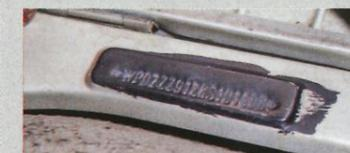
3 Le numéro de châssis est gravé au-dessus du réservoir.
