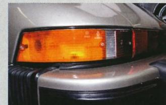
**3** Les cabochons des feux sèchent avec le temps. Il suffit simplement de les remplacer.
