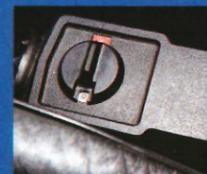
Entre les deux sièges, on gère l'ouverture des volets.
