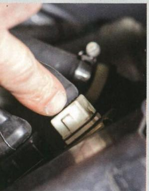
**5** Le connecteur du fil de la sonde de température donne souvent lieu à des pannes moteur. Rien de grave, mais il faut tout de même accéder au 3<sup>e</sup> cylindre pour le remplacer.
