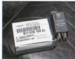
**1** Sous le siège, le relais DME (électrique moteur) peut poser problème. Les contacts s'abîment et empêchent le démarrage. Mieux vaut le changer en prévention.
