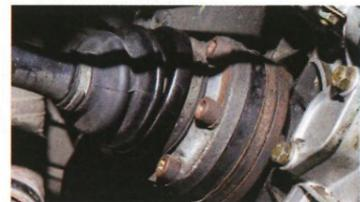
1 Les soufflets des cardans ne doivent pas être percés ni poreux.
