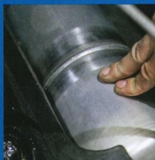
2 À gauche, la réserve d'air des suspensions pneumatiques.
