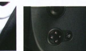
4 Sous le côté droit du volant, la commande pour régler sa profondeur et sa hauteur.
