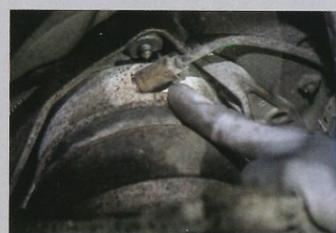
**1** La soupape qui retient l'air dans l'amortisseur pneumatique peut poser des problèmes. Elle se grippe et l'air n'est plus contenu, ce qui provoque le dégonflage de l'amortisseur. Cela se remarque quand l'auto est affaissée d'un côté. Rassurez-vous, cette soupape coûte aux alentours des 120 €.
