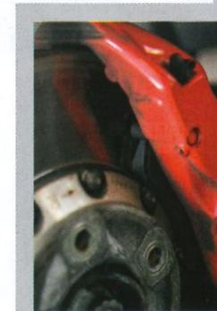
Comme pour acheter n'importe quelle voiture, il faut inspecter les freins. Les plaquettes doivent encore avoir de la matière et aucune voilure ne doit apparaître sur les disques.
